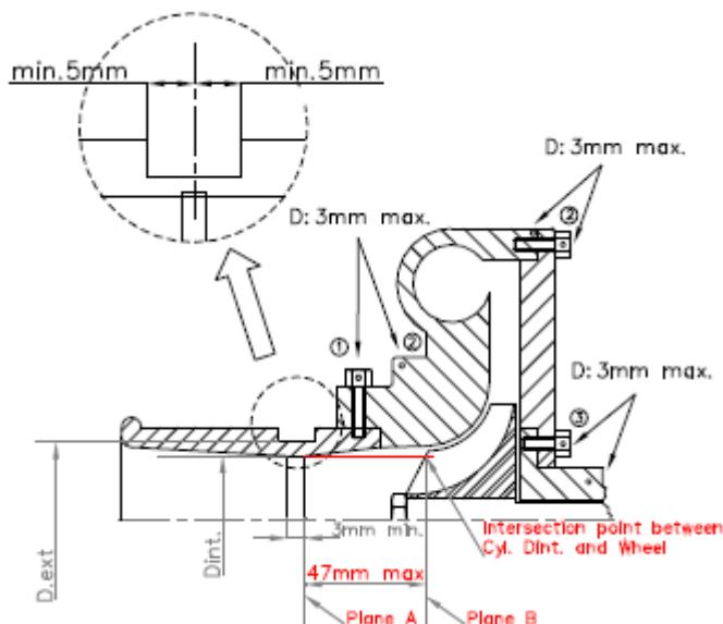
Die Kompressoren, die die obigen Dimensionen respektieren, müssen beibehalten werden. Alle anderen müssen mit einem fest installierten Luftbegrenzer ausgestattet sein, der am Kompressorgehäuse mit den oben definierten Abmessungen befestigt ist. Die gesamte Verbrennungsluft muss durch den Luftbegrenzer strömen. Falls der Einlass am Kompressor **45 mm** nicht überschreitet, ist ein zusätzlicher Luftbegrenzer nicht erforderlich.
