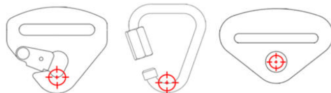
Beispiele von Anlenkpunkten der Gurtbefestigung
