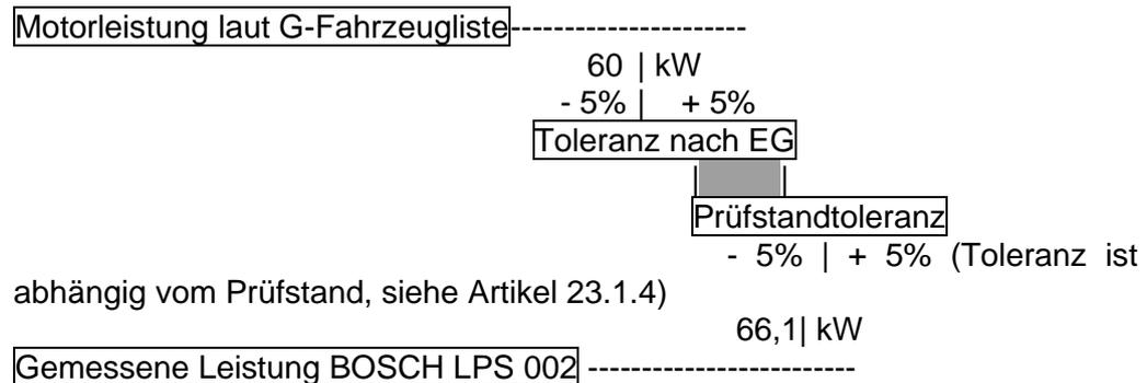
Das Messprotokoll weist eine Radleistung von 60,36 kW aus, die Temperatur der Ansaugluft betrug 44°C und der barometrische Druck 946 mbar:
