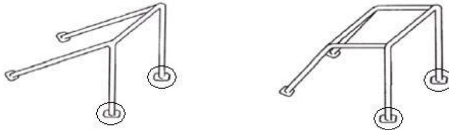
Die in diesen Sicherheitsbestimmungen geforderte Verstärkungsplatte mit einer Fläche von mindestens 120 cm<sup>2</sup> ist an den auf den vorstehenden Zeichnungen eingekreisten Befestigungspunkten vorgeschrieben und muss sowohl innerhalb als auch außerhalb des Fahrgastraumes angebracht sein. Alternativ zu den außenliegenden Verstärkungsplatten ist es ausreichend, wenn die innen vorgeschriebenen Platten mit der Karosserie verschweißt sind.
