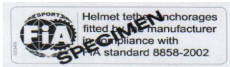
FIA-Label gemäß FIA-Standard 8858-2002 (Farbe Silber mit Hologramm)
