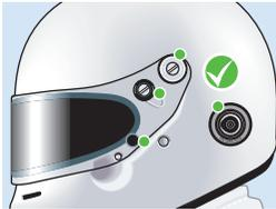
Prüfen Sie, ob die Verankerungsbolzen und die Befestigungen des Visiers funktionsfähig und unbeschädigt sind.
