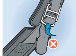
Vergewissern Sie sich, dass der Kinnriemen nicht eingeklemmt oder beschädigt ist.
