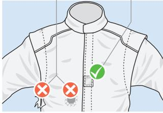
FIA Hologramm hinter der Reißverschlussklappe
