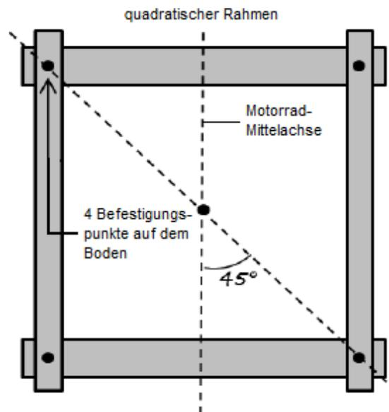
Fahrzeuge mit Getrieben ohne Leerlauf müssen auf einem Ständer abgestellt werden. Es ist zu bevorzugen, die Geräuschmessung auf einem weichen Untergrund, nicht schallreflektierend, z.B. Gras oder feinem Schotter, durchzuführen. Bei übermäßigem Wind müssen die Maschinen gegen den Wind gerichtet sein. Das Umgebungsgesch in einem Radius von 5 m um das Antriebsaggregat darf während der Tests 90 dB (A) nicht überschreiten.
