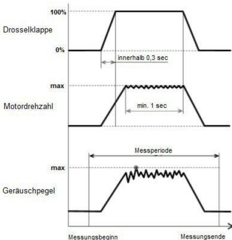
1. Der Prüfer muss die Drosselklappe innerhalb von 0,3 Sekunden vollständig öffnen (Vollgas).
