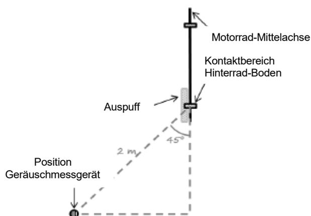
Quads - Auspuff auf Mittelachse - Draufsicht
