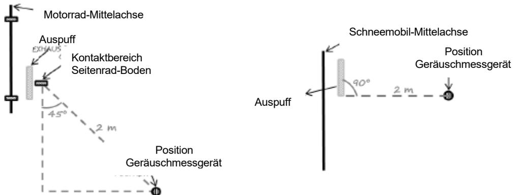
Bei Motoren mit mehr als einem Schalldämpfer wird der Geräuschpegel an jedem Auspuffende gemessen. Schalldämpfer mit Adaptern zur Reduzierung des Geräuschpegels müssen dauerhaft eingebaut sein. Für repräsentative Messungen können alle Motorräder in einem auf dem Boden befestigten Rahmen positioniert werden, um sicherzustellen, dass die 45°-Vorgabe eingehalten ist. Ein quadratischer Rahmen hilft bei der Positionierung des Motorrads.
