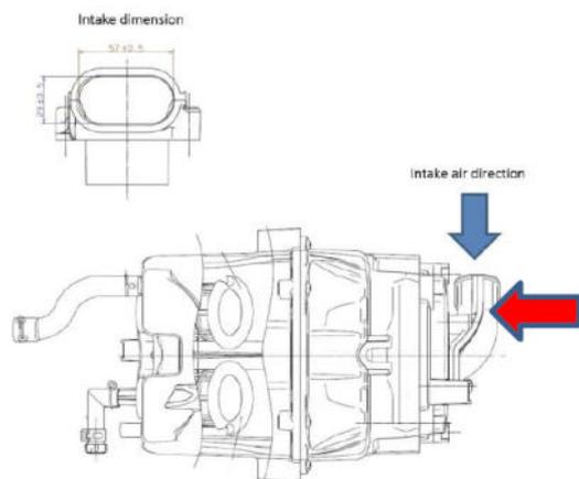
Dieses Bauteil darf vollständig bis zur Luftfilteröffnung ausgeschnitten werden
