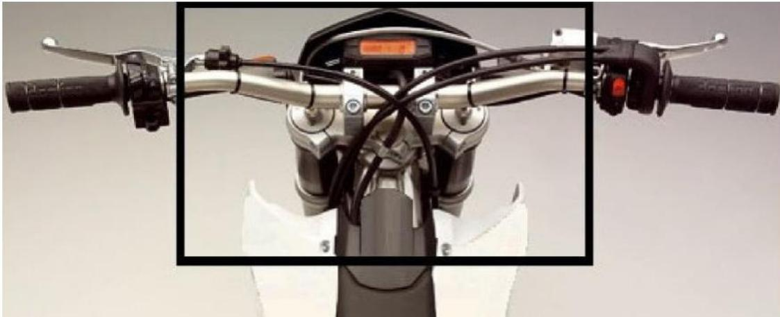
*Nur für die Klasse B zusätzlich vorgeschriebene Anforderungen*: ZWEI Leuchten (z. B. LED-Repeater) müssen aus einer Entfernung von 10 Metern auf beiden Seiten des Motorrads sichtbar sein (in dem gekennzeichneten Bereich, siehe nachstehende Abbildung). Diese beiden Seitenleuchten müssen vor jeglichem Kontakt (Fahrer, Umgebung usw.) geschützt werden.
