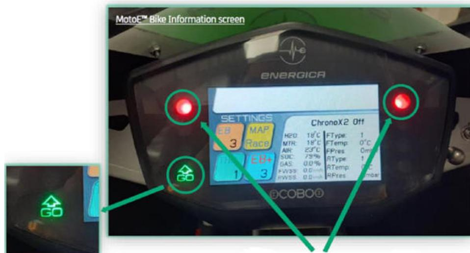
Kontrollleuchte AN zeigt an, dass das Motorrad und der Gasgriff aktiv sind.
